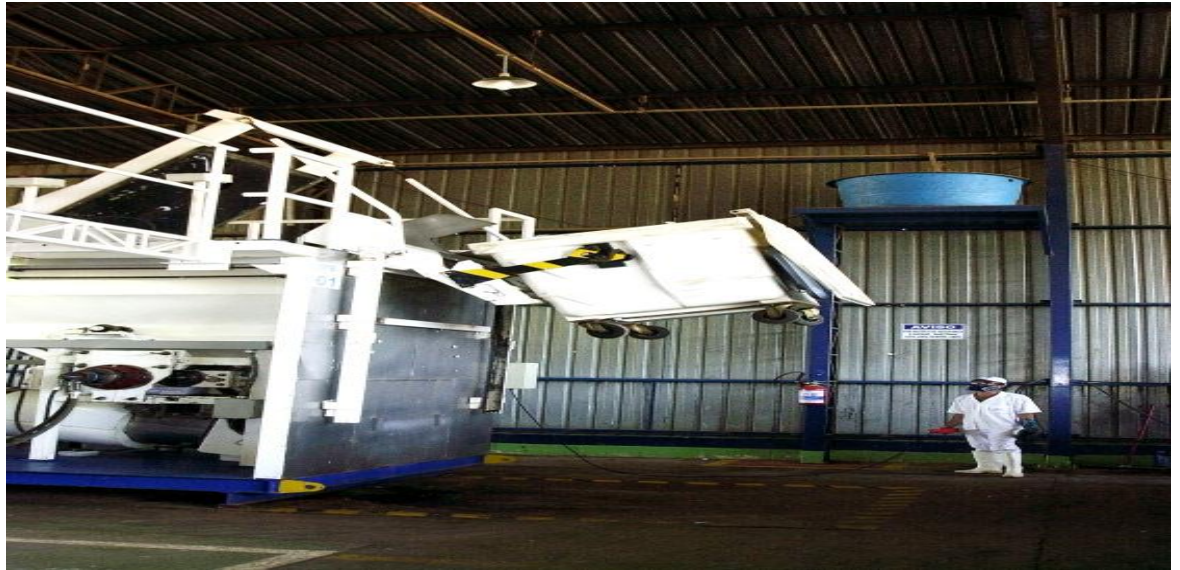
foto - Basculamento de container para o equipamento.
