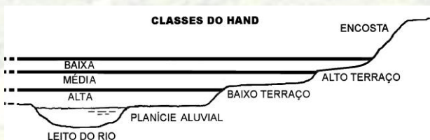
Figura 5.12 - Classes de fatiamento adotadas no âmbito da aplicação do modelo HAND em planícies e terraços.
