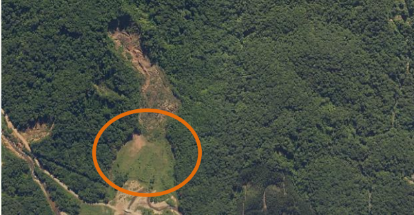
Figura 5.23 - Depósito de acumulação em sopé de encosta, com indicação de suscetibilidade local a movimentos gravitacionais de massa - Ilhota, SC.
