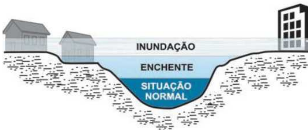
Figura 82. Perfil esquemático do Processo de Enchente e Inundação - Fonte: Brasil (2007)
